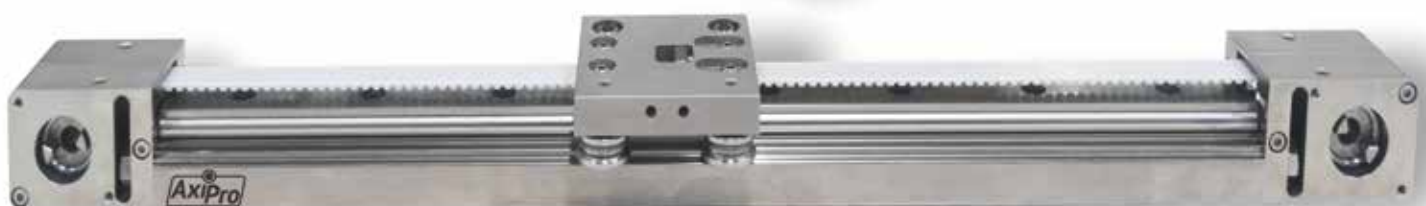
Lineaire units zijn geleidingen met een slede die wordt bewogen door bijvoorbeeld een tandriem of spindel. Voor de aandrijving kunnen zowel AC/DC, servo- als stappenmotoren worden toegepast. Dit afhankelijk van de gewenste snelheid, kracht en positioneer-nauwkeurigheid.
